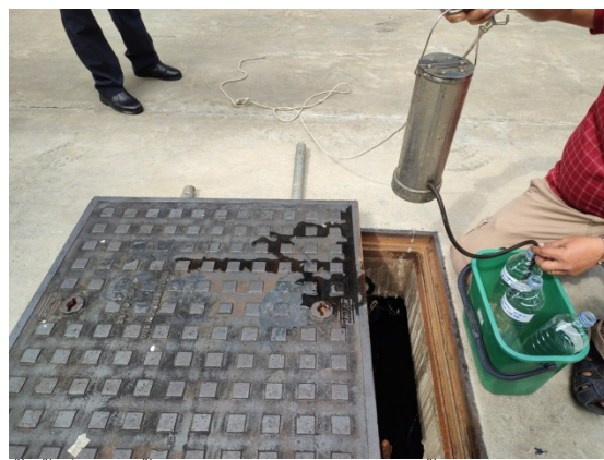
เก็บตัวอย่างน้ำทิ้งที่บ่อพักน้ำใสหลังจากจากระบบบำบัดน้ำเสีย ด้วยวิธี Sampling Pump
